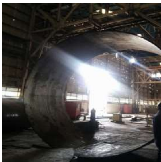
Salah satu komponen peralatan Fixed Cone Valve dalam proses fabrikasi
